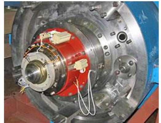
Статорные части поставляются в полной укомплектованности, готовые к монтажу в корпус компрессора.
